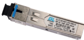
GL-OT-SG14SC1-1310-1550-I-D Промышленный SFP, WDM, 1 Гбит/с, одно волокно SM, SC, Tx:1310/Rx:1550 нм, 14 дБ, до 20 км
