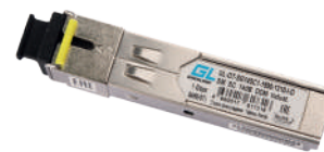
GL-OT-SG14SC1-1550-1310-I-D Промышленный SFP, WDM, 1 Гбит/с, одно волокно SM, SC, Tx:1310/Rx:1550 нм, 14 дБ, до 20 км
