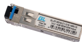
GL-OT-SG14LC1-1490-1310-I-D Промышленный SFP, WDM, 1 Гбит/с, одно волокно SM, LC, Tx:1490/Rx:1310 нм, 14 дБ, до 20 км
